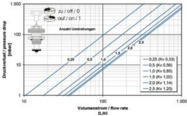
Das Einstelldiagramm berücksichtigt bereits die Einzeldruckverluste des Durchflussmessers, des Regulierventils sowie zwei Klemmverschraubungen.
